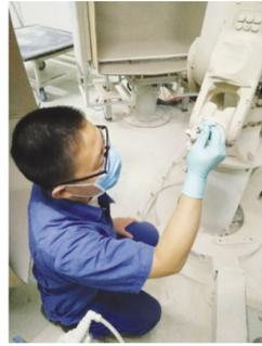
月中旬姚玖洪与我到扬州荣德技术交流,学习了双枪喷涂改造过程中的成功经验。我们借鉴了对方使用过程中的优点,缩短了我们的改造时间与试验调试周期,大大降低了试验风险。从浆料配比、喷涂坩埚侧壁底部距离调整、气压大小和浆料流进吐出量等参数,到喷涂轨迹进一步优化。同时也交流了喷涂工序不少细节问题,少走了不少弯路。我们2号自动喷涂站的双枪改造,由技术部发起,设备部负责改造,质量、生产、物料共同配合。
