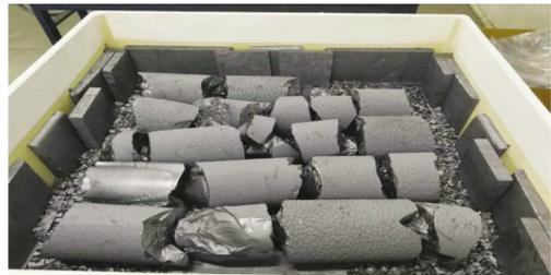
3.装料工序:头尾料、边皮与坩埚距离的放置,装料料,尺寸10mm以内的小料及大块填充硅料、母合金放置的细节,我们都要仔细观察、巡检到位。
